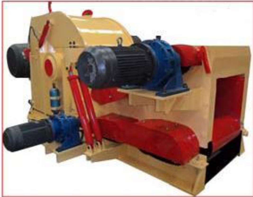
German Hacker Typ TH 350/800/3 Antrieb 220 kW Baujahr 2011 Leistung 10-12 Tonnen
